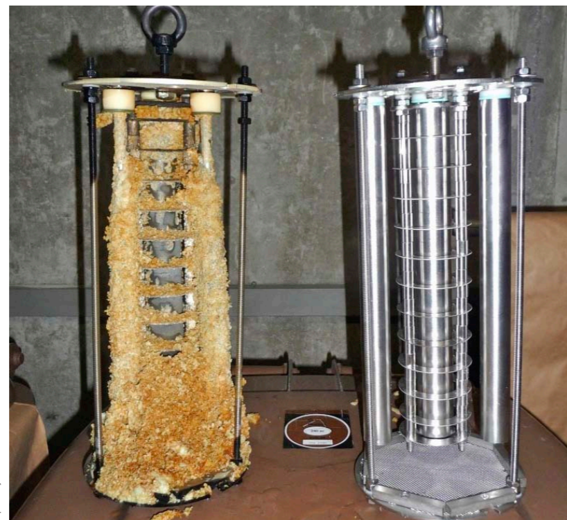
Verbrauchte Anoden zeigen Wirkung an (links) und neue Magnesiumanoden
