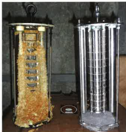
Bild 3 Verbrauchte und neue Magnesiumanoden
