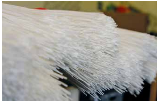
Die Membranfasern aus Kunststoff haben eine Porengröße von nur 20 nm. Zum Vergleich: Ein menschliches Haar ist 60000 nm dick.
